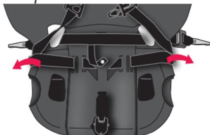
Sangle du connecteur d'ancrage inférieur en position face vers l'arrière
