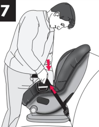
En se servant de tout son poids, pousser fermement le dispositif de retenue pour enfant sur le siège du véhicule alors que la sangle du connecteur d'ancrage inférieur est serrée.
