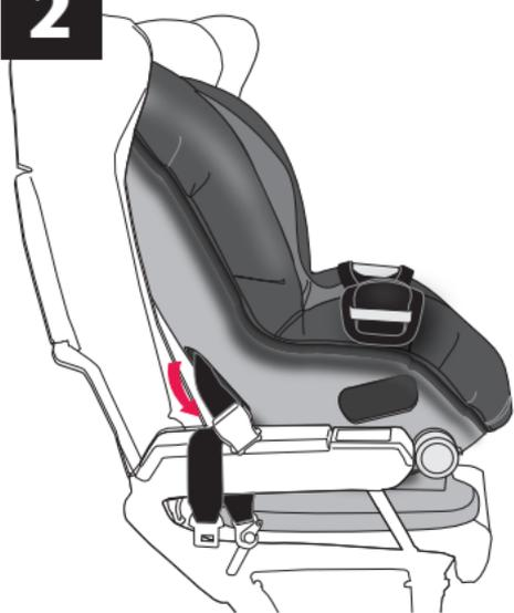
Faire passer la ceinture de sécurité de l'avion par l'ouverture du passage de la ceinture pour la position face vers l'avant située sur l'arrière du dispositif de retenue et continuer à faire passer par l'ouverture du passage de la ceinture de l'autre côté du dispositif de retenue pour enfant.
