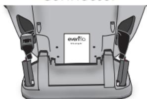
Retirer les deux crochets des connecteurs d'ancrage inférieur ou les pinces des pinces de rangement situées sur la base.
