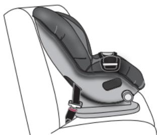
Attacher la ceinture de sécurité du véhicule, comme illustré, en fonction du type de ceinture de sécurité.
