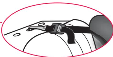
Attacher le crochet d'ancrage au point d'ancrage du véhicule situé derrière le siège du véhicule, comme illustré. (Consulter le manuel du propriétaire du véhicule, car l'emplacement du point d'ancrage peut varier.) Tirer sur la sangle pour bien serrer la courroie d'ancrage.
