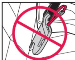
**IMPORTANT:** S'assurer que les deux connecteurs d'ancrage inférieur Quick Connectors sont orientés vers le haut et que les sangles ne sont pas tordues.
