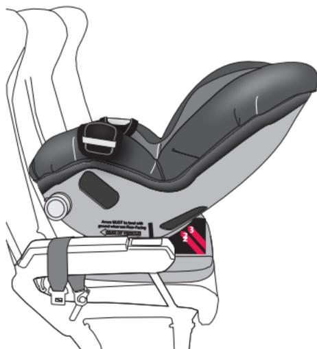
Détacher la boucle de la ceinture de sécurité de l'avion et placer les deux parties de la ceinture sur les accoudoirs, comme illustré. Régler le dispositif de retenue pour enfant en position inclinée (p. 26) et le mettre sur le siège de l'avion en position **face vers l'arrière.**
