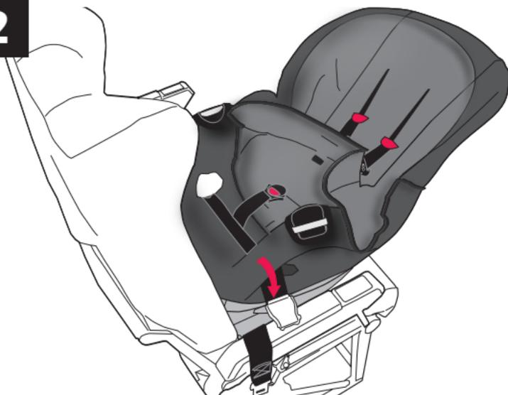
Retirer le revêtement du siège de l'avant du dispositif de retenue pour enfant. Faire passer la ceinture de sécurité de l'avion par l'ouverture du passage de la ceinture pour la position face vers l'arrière située sur l'un des côtés et continuer à la faire passer par l'ouverture du passage de la ceinture de l'autre côté du dispositif de retenue pour enfant, comme illustré plus haut.
