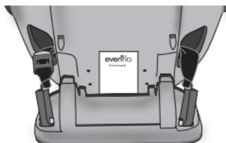
Retirer les deux crochets, ou pinces, du connecteur d'ancrage inférieur de la base.
