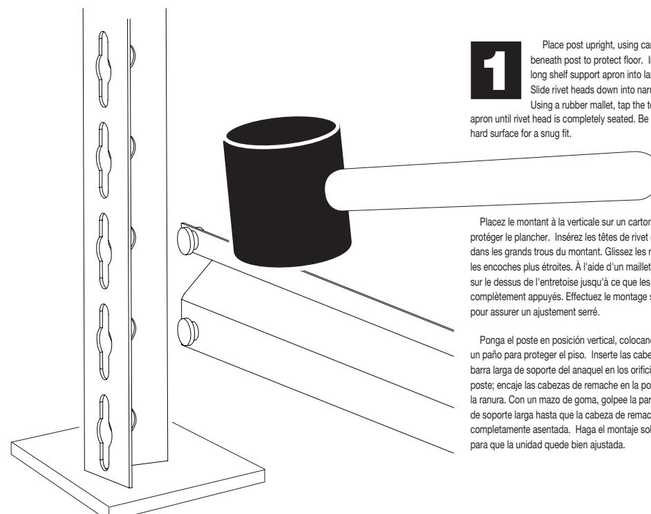
Placez le montant à la verticale sur un carton ou un chiffon pour protéger le plancher. Insérez les têtes de rivet de la grande entretoise dans les grands trous du montant. Glissez les rivets vers le bas dans les encoches plus étroites. À l'aide d'un maillet en caoutchouc, frappez sur le dessus de l'entretoise jusqu'à ce que les rivets soient complètement appuyés. Effectuez le montage sur une surface solide pour assurer un ajustement serré.
