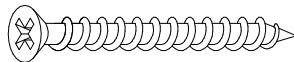
36 x 26 M4 x 38mm Screw M4 x 38mm de la vis M4 x 38mm el tornillo
