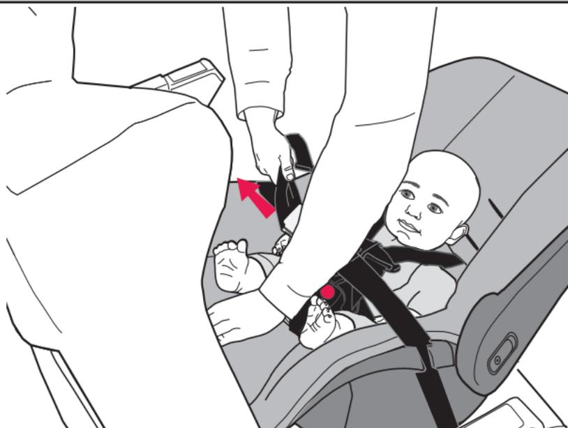
La ceinture de sécurité de l'avion doit être aussi serrée que possible. En se servant de tout son poids, pousser fermement le dispositif de retenue pour enfant sur le siège de l'avion tout en tirant sur l'excédent de la ceinture de sécurité pour serrer. Faire passer l'excédent de la ceinture de sécurité du siège vers l'arrière par les fentes de ceinture, comme illustré plus haut.
