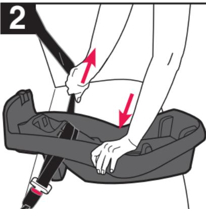
Tirer fermement sur la ceinture baudrier pour retirer tout jeu de la portion sous-abdominale de la ceinture de sécurité du véhicule tout en appuyant de tout son poids sur la base. Vérifier que la base est installée en toute sécurité sur le siège du véhicule.
