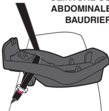
**IMPORTANT** : Certaines ceintures de sécurité de véhicule équipées d'un ELR peuvent être mises en mode de verrouillage pour l'installation du dispositif de retenue pour enfant. Dans ces cas, l'utilisation d'une pince de sécurité ne sera peut-être pas nécessaire.
