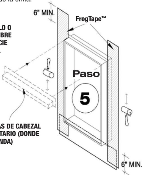
Figura 6 Aplique el tapajuntas de umbral en la jamba.
