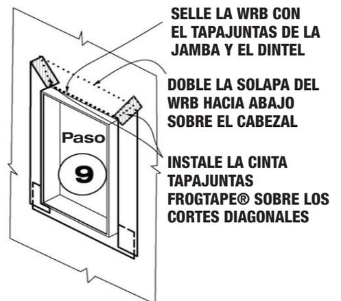
**Figura 10** Despliegue la solapa del cabezal, séllela y péguela en su sitio.
