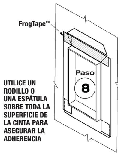
**Figura 9** Aplique el tapajuntas de cabezal.
