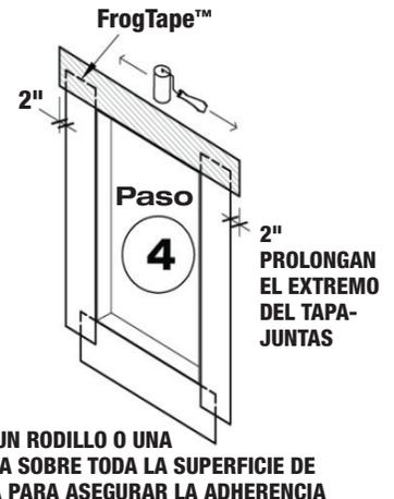
Figura 5 Aplique el tapajuntas de cabezal.
