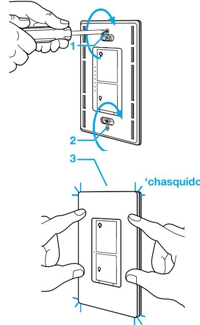
(Si instaló el interruptor al lado de otros interruptores o atenuadores, debe instalar una placa de pared que tenga la cantidad correcta de orificios y del tamaño correcto para instalar todos los dispositivos.)
