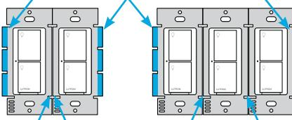
Cada interruptor tiene las secciones laterales internas quitadas. El interruptor del medio tiene todas las secciones laterales quitadas.
