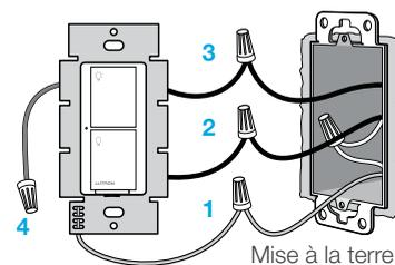
1 Raccordez le fil de « mise à la terre » nu en cuivre (ou vert) du boîtier mural au fil vert du interrupteur à l'aide d'un connecteur de fils.
