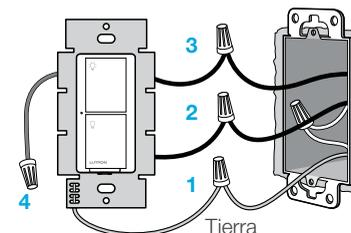
1 Conecte el cable a "tierra" de cobre sin protección (o verde) desde la caja de pared al cable verde del interruptor utilizando un conector de cable.
