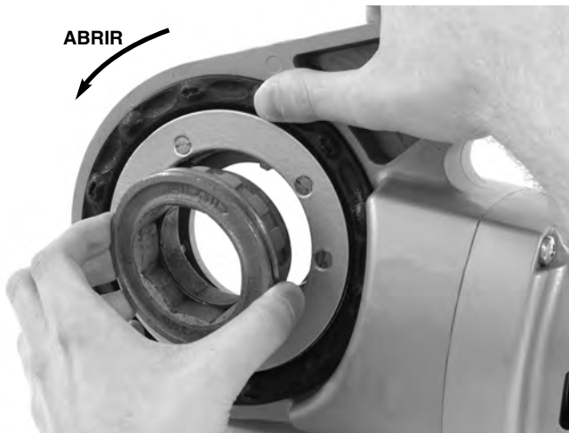
Figura 8 – Montaje del adaptador en la máquina 690-I
