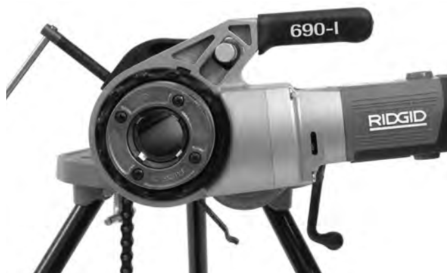
Figura 12 – Orientación correcta del accionamiento motorizado
