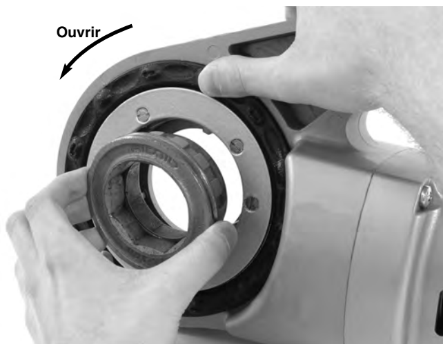
Figure 8 – Installation de l'adaptateur sur la 690-I
