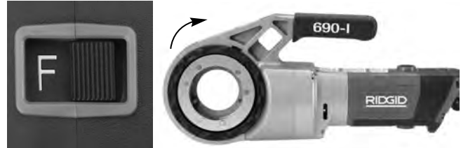
Figura 6A – Posición de avance (F) (hacia la derecha) del interruptor
