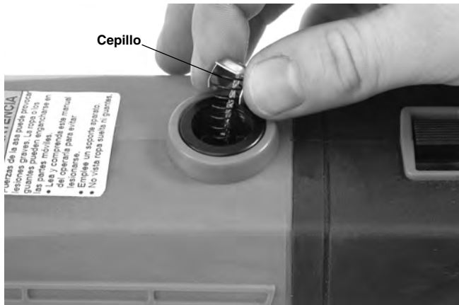
Figura 18 – Colocación del cepillo
