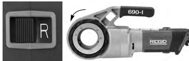
Figura 6B – Posición de retroceso (R) (hacia la izquierda) del interruptor
