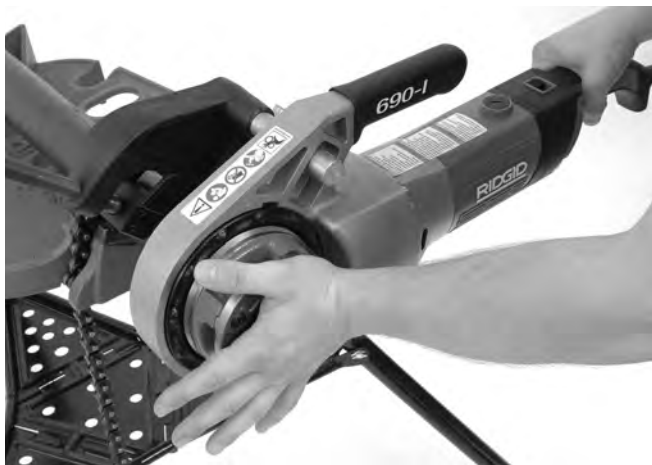
Figura 13 – Inicio del roscado
