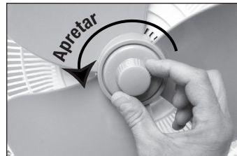
Enrosque la tapa de las hojas en la rosca del eje del motor. Nota: las roscas están al revés. Apretar = contrario a las agujas del reloj.
