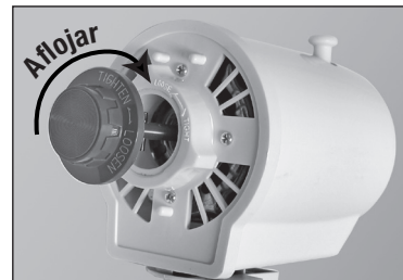
Saque la tapa de la hoja haciéndola girar HACIA LA DERECHA mientras sujeta el eje de metal fuertemente. Nota: Las roscas están al reverso. Destornille=Hacia la derecha.
