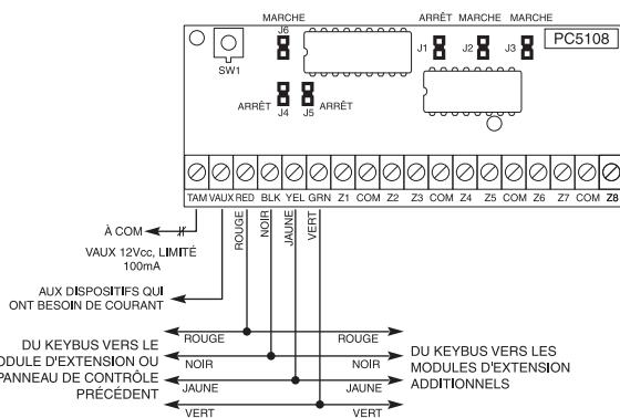
**TAM** - Elle peut être utilisée pour Protéger le coffret dans lequel le PC5108 est monté. Connectez un interrupteur normalement fermé (NF) entre TAM et BLK (noir). Si l'anti-sabotage n'est pas utilisé, connectez un fil entre TAM et BLK (noir).
