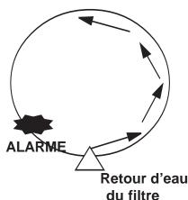
Si l'eau qui revient du filtre est placée à 6 heures et le courant est dans le sens contraire des aiguilles d'une montre, le meilleur emplacement pour l'alarme est entre la position de 8 heures et 9 heures. Par contre, si le courant est dans le sens des aiguilles d'une montre, l'alarme devrait être placée entre la position de 3 heures et 4 heures.
