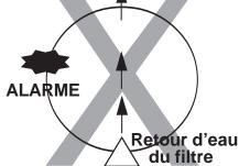
Ne pointez pas la bille du retour d'eau vers le centre avec l'alarme sur le côté. Le courant du retour d'eau perturbera, et ainsi le détecteur de l'alarme ne pourra pas détecter le mouvement de la vague correctement
