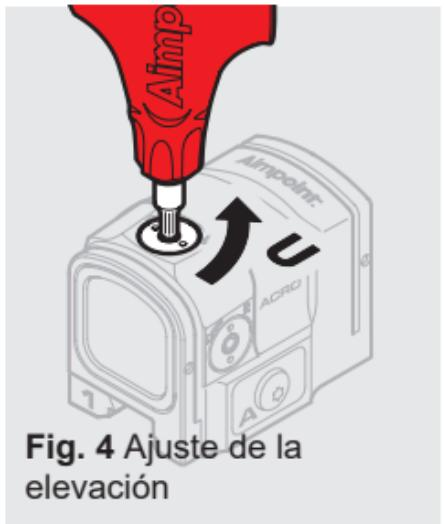
**Fig. 4** Ajuste de la elevación
