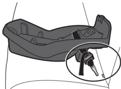
Acople el gancho derecho a la barra de anclaje derecho y el gancho izquierdo a la barra de anclaje izquierdo. **VUELVA A COMPROBAR** que los ganchos están acoplados por completo, jalando con fuerza la correa del conector del anclaje inferior.
