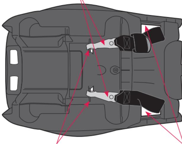
Almacenamiento del conector del anclaje inferior
