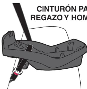
**IMPORTANTE:** Algunos cinturones de seguridad con retractor de bloqueo de emergencia se pueden poner en modo de bloqueo para la instalación del sistema de sujeción infantil. Es posible que no sea necesario usar un clip de bloqueo en estos casos. Para instalar un clip de bloqueo, consulte la página 44.
