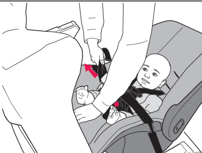
El cinturón de seguridad del avión debe estar lo más apretado posible. Usando todo su peso, empuje el sistema de sujeción infantil firmemente contra el asiento del avión, mientras jala el exceso de la correa del cinturón de seguridad para apretarlo. Pase el exceso de la correa del cinturón de seguridad a través de las ranuras del cinturón, como se muestra arriba.
