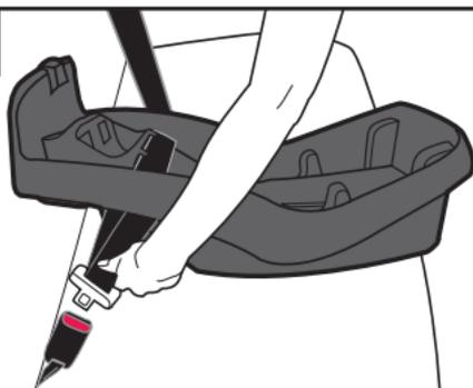
Pase el cinturón del asiento a través de la base (o del sistema de sujeción infantil) y abroche el cinturón de seguridad.
