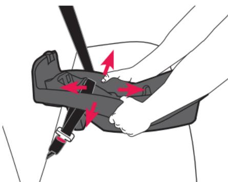
**NO** use este sistema de sujeción infantil si se mueve más de 2,5 cm (1 in) hacia delante o de lado a lado en la guía del asiento del vehículo. Mueva el sistema de sujeción infantil a otro lugar de asiento, intente tensar de nuevo el cinturón de seguridad o utilice los anclajes inferiores en su lugar.
