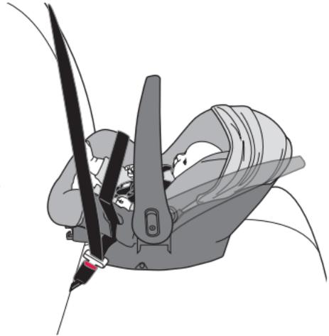
**IMPORTANTE:** Si se necesita un clip de bloqueo, consulte la página 44. Algunos cinturones de seguridad con retractor de bloqueo de emergencia se pueden poner en modo de bloqueo para la instalación del sistema de sujeción infantil. Es posible que no sea necesario usar un clip de bloqueo en estos casos. Consulte el manual del propietario del vehículo para determinar el tipo de retractor del cinturón que tiene el vehículo.
