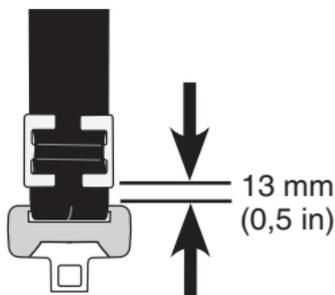
**Nota:** El clip de bloqueo debe colocarse a una distancia máxima de 13 mm (0,5 in) de la hebilla del cinturón de seguridad.
