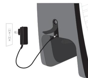
Inserte el enchufe en un tomacorriente de 120V. Luego inserte el adaptador de corriente alterna (Alternative Current, AC) en el ventilador.
