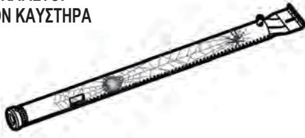
Αν διαρκώς δυσκολεύεστε να ανάψετε τη συσκευή μπάρμπεκιου ή αν η φλόγα είναι αδύναμη, ελέγχετε και καθαρίστε τους σωλήνες Venturi και τους καυστήρες.
