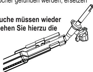
9. Befestigen Sie die Elektrode am Brenner.
