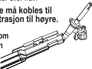
9. Fest elektroden til brenneren.
