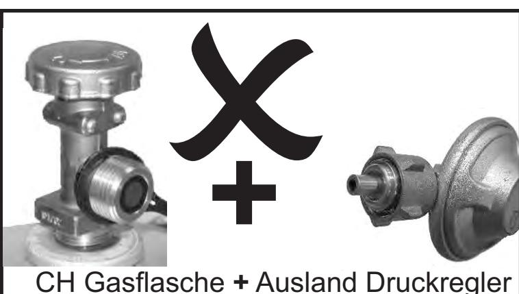
Durch die unterschiedlichen Dichtungssysteme ist es unmöglich, den Regler ordnungsgemäß mit den Gastank zu versiegeln. Hier wird Gas entweichen und kann durchaus durch Flammen oder Funken Feuer fangen und sich entzünden. Ein Lebensbedrohliche Explosion und/oder Schäden ihres Eigentums könnten entstehen. Schweizerische und deutsche Gasflasche und Druckregler können nicht miteinander zusammengeführt werden.
