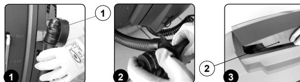
5. Liberar de las sujeciones el accesorio de limpieza del tanque (3), situado en la parte trasera de la máquina (Fig.4).
