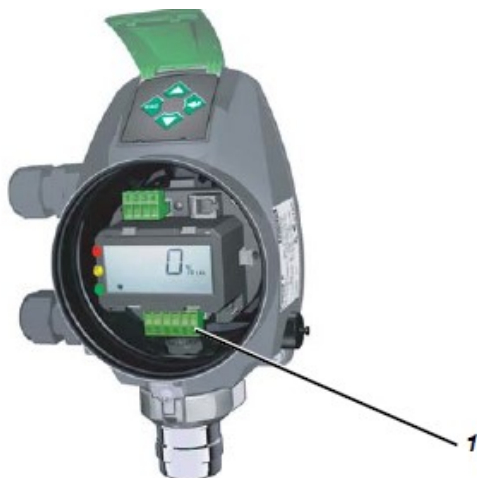
Abbildung 11 Position des Relais
