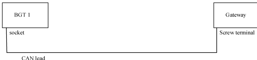
Abbildung 138 Anschluss SUPREMA-Gateway CAN/Profibus DP
