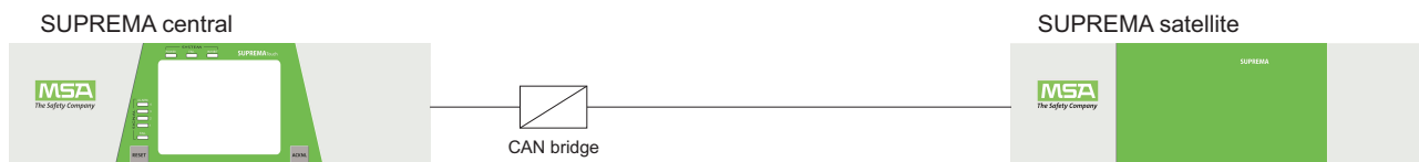
Abbildung 99 System mit einem Satelliten und CAN-Brücke
