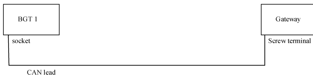
Figura 138 Conexión de la puerta de enlace SUPREMA Can/Profibus DP
