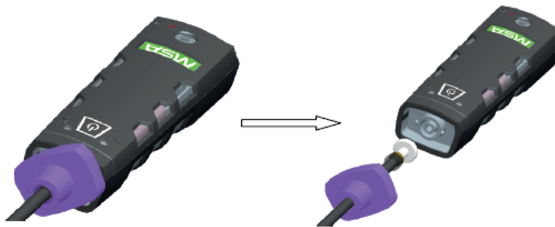
Figure 3 Remplacement du filtre de la sonde
