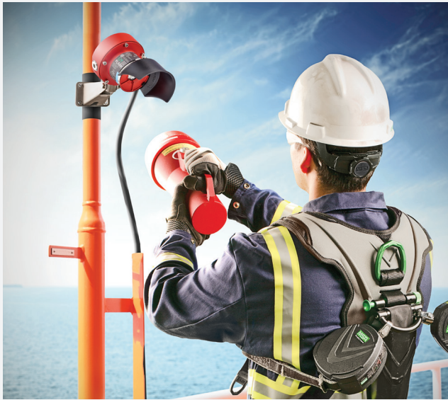
Fig. 3 — Détecteur de flamme testé avec une lampe de test
