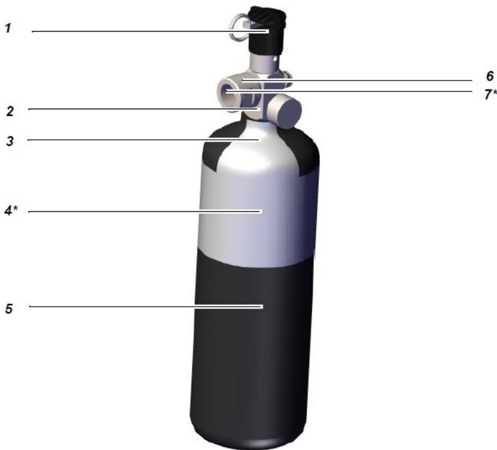
Figure 3 Vue d'ensemble de la bouteille d'air comprimé en matériau composite avec robinet détenteur de pression (S-Cap-Air)
