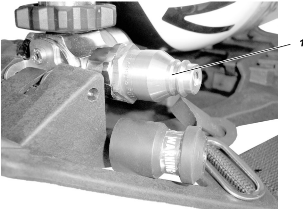
Abb. 17 Füllen mit dem Quick-Fill (optionale Ausrüstung)
