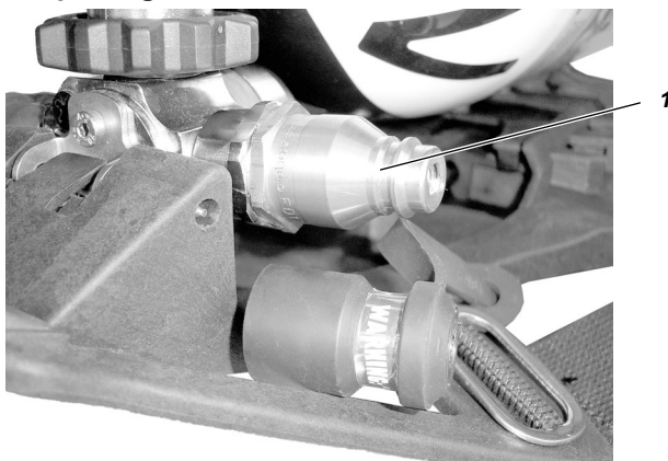
Fig. 17 Remplissage avec le raccord Quick-Fill (en option)
