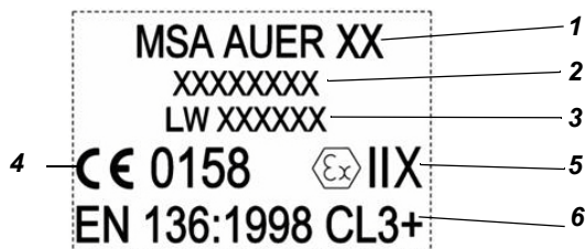
Fig. 2 Marcado del cuerpo de la máscara completa
