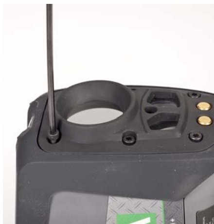
Fig. 17 Tornillos que deben retirarse del elemento de retención de la lente de germanio
