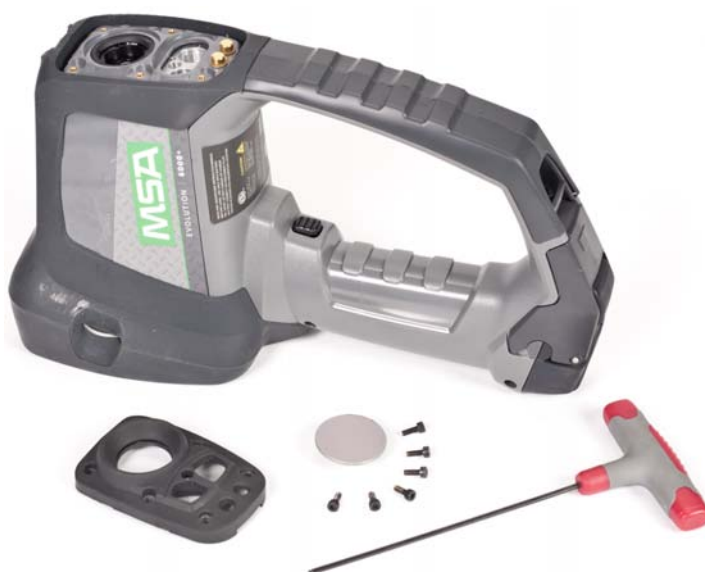
Fig. 16 Elemento de retención, piezas y herramientas de la lente de germanio
