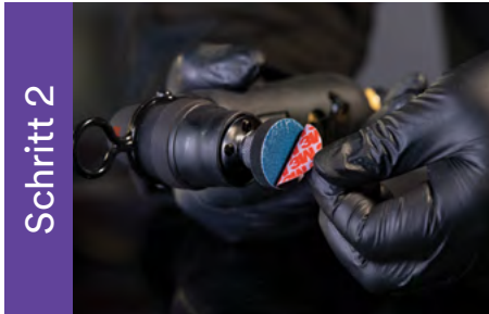
Schritt 2 Die Schleifscheibe auf das Auflagepad legen.
