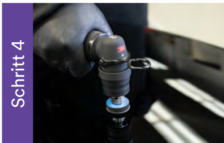
Schritt 4 Den Defekt je nach Größe 1–3 Sekunden schleifen.
