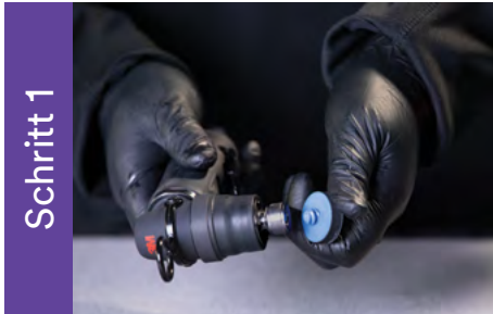
Schritt 1 Stützteller auf den Tellerschleifer auflegen.
