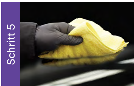
Schritt 5 Die Fläche mit einem Mikrofasertuch reinigen und die Reparatur prüfen.
