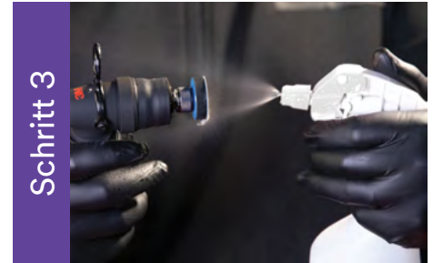
Schritt 3 Die Schleifscheibe vor dem Schleifen mit Wasser besprühen, um Zusetzen zu vermeiden.
