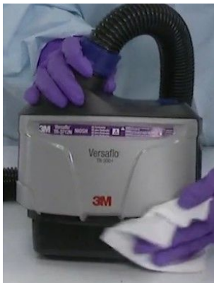
Figure 3: Limpieza de la superficie exterior de la batería
