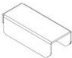
A5 SHELF BRACKET - A4M03141 (x2) 5/8"x7/8"x2 1/16" (16x22x53)
