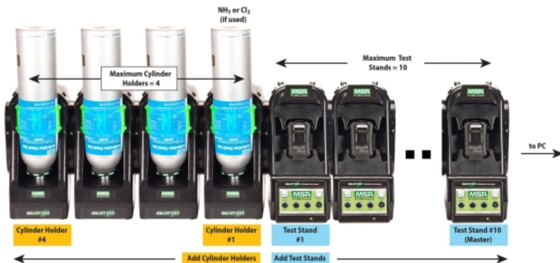
Figure 8 Bancs d'essai et supports de bouteille installés correctement en une rangée
