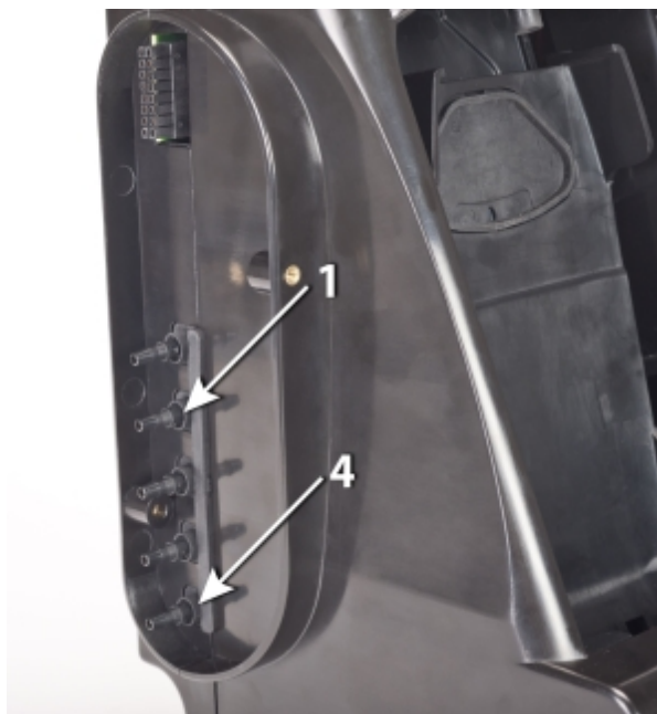
Figure 15 Orifices d'entrée de gaz sur le banc d'essai
