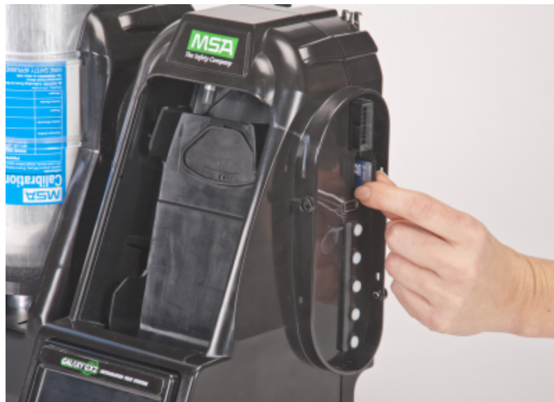
Figure 11 Installation d'une carte mémoire SD ou SDHC
