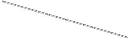
F02 LOUVER TIE STRAP - A4M02573 (x1) 1/8"x13/16"x95 1/16" (3x20x2414)
