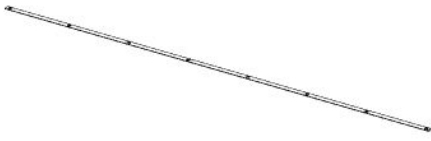
F01 FLAT BAR - A4M02572 (x1) 1/16"x1"x92 13/16" (2x25x2357)
