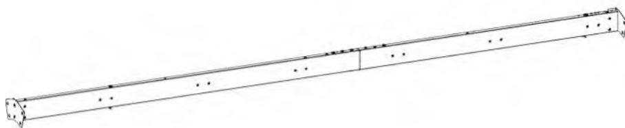
ASSEMBLAGE DE POUTRE DE FAÎTAGE D'ÉTAPE - 24A
