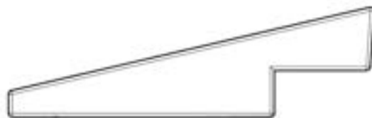
W03 CONTREVENTEMENT D'ANGLE - W4L22911 (x2) 1 15/16"x3 3/8"x11 1/4" (50x86x285)
