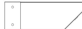
D06 | EXTRÉMITÉ DE SOLIVE - W4L15530 (2) | 1 3/8 po x 5 1/4 po x 15 po (36 x 134 x 382)
