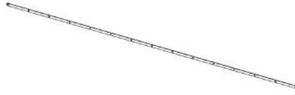
F02 SANGLE D'ATTACHE POUR PERSIENNES - A4M02573 (x1) 1/8"x13/16"x95 1/16" (3x20x2414)
