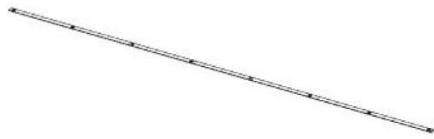
F01 BARRE PLATE - A4M02572 (x1) 1/16"x1"x92 13/16" (2x25x2357)
