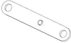
F03 SANGLE DE LIAISON - A4M02229 (x1) 1/8"x11/16"x3 13/16" (3x17x97)
