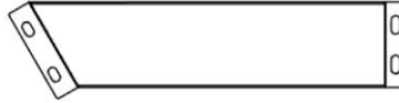
B09 SUPPORT DE PIGNON - A4M04319 (x3) 1 1/2 po x 5 15/16 po x 24 5/8 po (38 x 152 x 625)
