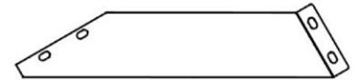
C04 CONTREVENTEMENT D'ANGLE - A4M04150 (x3) 1 1/2 po x 5 15/16 po x 27 1/16 po (38 x 151 x 687)
