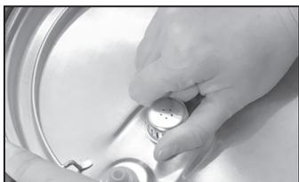
8. Retire el sellador de la válvula flotante (1) mientras sujeta la válvula flotante desde el otro lado de la tapa. Luego retire la válvula flotante (2).
