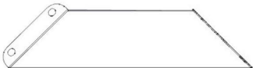
C01 ASSEMBLAGE D'ENCORBELLEMENT — A4M03525 (x1) 21 13/16"x5 1/4"x2 3/4" (70x134x553.5)
