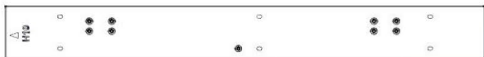
H10 ASSEMBLAGE DE CANAL DE CHARNIÈRE D'ARMOIRE DE FOUR À PIZZA — A4M03686 (x1) 26 9/16"x2 15/16"x2 1/8" (54.00x74.80x674.00)
