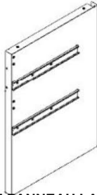
S5 ASSEMBLAGE DE PANNEAU LATÉRAL D'ARMOIRE D'ÉVIER M — A4M03567 (x1) 33 3/8"x23 3/8"x2 3/16" (56.20x593.00x847.00)
