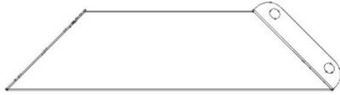
C02 ASSEMBLAGE D'ENCORBÈLEMENT — A4M03526 (x1) 21 13/16"x5 1/4"x2 3/4" (70x134x553.5)
