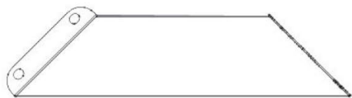
C01 ASSEMBLAGE D'ENCORBÈLEMENT — A4M03525 (x1) 21 13/16"x5 1/4"x2 3/4" (70x134x553.5)
