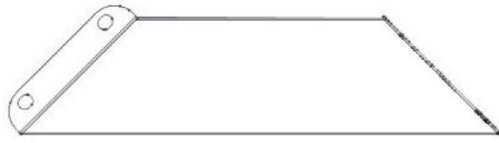
C01 ASSEMBLAGE D'ENCORBLEMENT — A4M03525 (x1) 21 13/16"x5 1/4"x2 3/4" (70x134x553.5)
