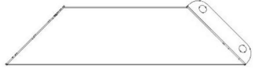
C02 ASSEMBLAGE D'ENCORBELLEMENT — A4MQ3526 (x1) 21 13/16"x5 1/4"x2 3/4" (70x134x553.5)
