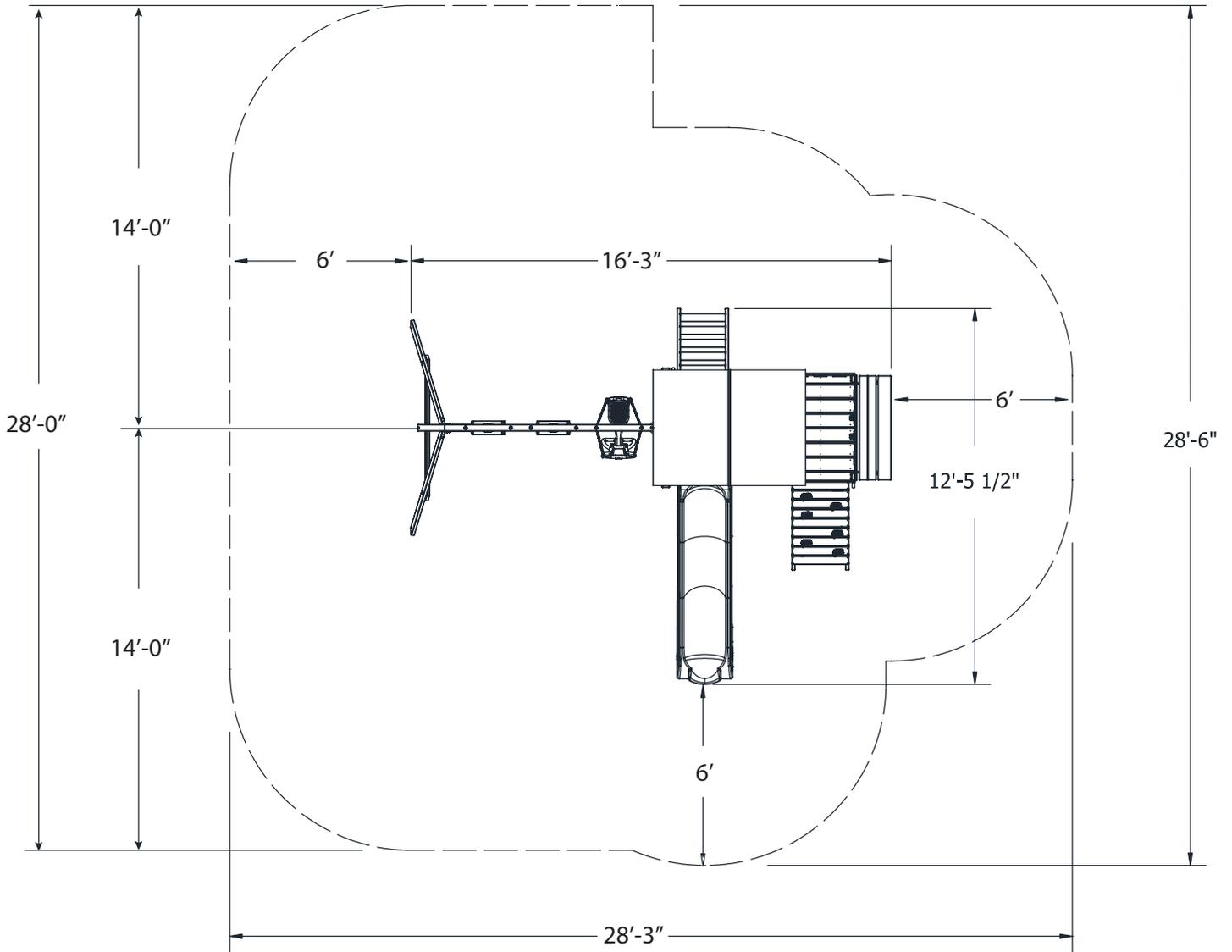
MINIMUM USE ZONE FOR PLAY EQUIPMENT SHALL EXTEND NO LESS THAN 72" FROM ALL SIDES OF THE PLAY STRUCTURE.
