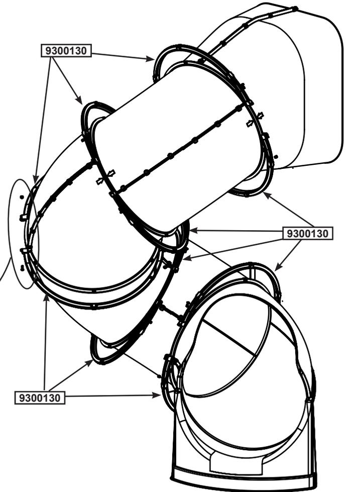
Nota: El juego inferior de abrazaderas puede girarse 90° para instalar los pernos y que el montaje resulte más sencillo.
