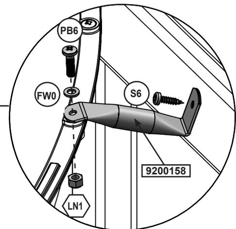
Coloque el perno de cabeza alomada (PB6) de 1/4 x 1" (6,4 x 25,4 mm) con arandela plana (FW0)
