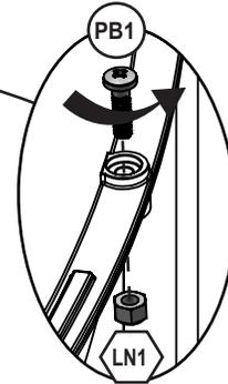
Retire el perno de cabeza alomada (PB1) de 1/4 x 3/4" (6,4 x 19,1 mm). El perno (PB1) ya no lo va a necesitar, pero debe guardar la tuerca de retención (LN1)
