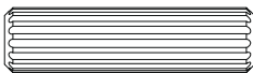
(G) WOOD DOWEL / SERVIETTE EN BOIS / CLAVIJA DE MADERA x 15 (Ø8 X 30MM)
