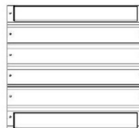
WP6 | PANNEAU CENTRAL GAUCHE - W2A03182 (x1) 1 1/4 po x 18 7/8 po x 20 7/8 po (32 x 478 x 536)
