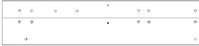
J06 ASSEMBLAGE DE BOUT DE SOLIVE- W2A04464 (x2) 15/16"x8 7/16"x37 1/8" (24x214x943)
