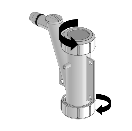
Figure 44. Montage de la purge des condensats
