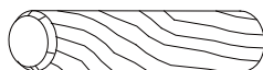
11 WOOD DOWEL/ SERVIETTE EN BOIS/ CLAVIJA DE MADERA x 16 (Ø8 X 30MM)
