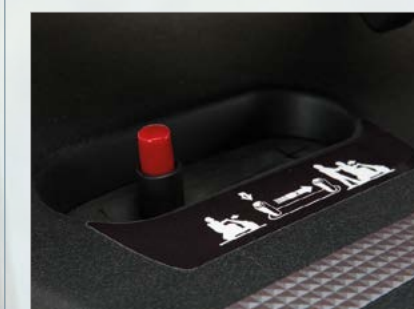
Levier de débrayage à deux niveaux pour éviter la roue libre
