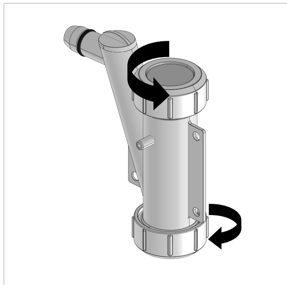
Figure 37 Montage de la purge de condensats
