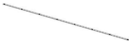
F01 BARRA PLANA - A4M02572 (x1) 1/16"x1"x92 13/16" (2x25x2357)
