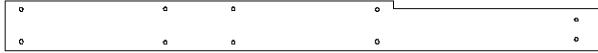
D1 SOPORTE DE LA VIGA DEL COLUMPIO - W4L19015 (x1) 1 3/8"x5 1/4"x62 3/8" (36x134x1585)
