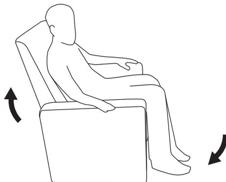
Pour ramener le fauteuil en position verticale, exercez une pression avec les jambes pour remettre le repose-pied dans sa position initiale.
