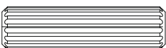
F Wooden dowel/ Clavija de madera/ Manchon en bois X 8 (ø8 X 30mm)
